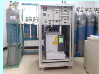
N 2 O:SHIMADZU GC-2014A (GC-ECD)
