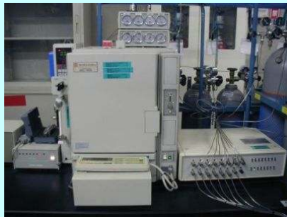
CH 4 :SHIMADZU GC-14BPF (GC-FID)
