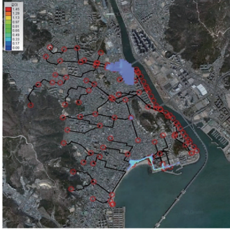
①(강우-유출)만에 의한 침수예상지역
