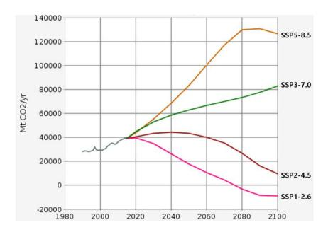
[그림 IV-15] 과거(1990~2014년) 및 미래(2015~2100년)에 대한 SSP 시나리오의 온실가스 배출 경로 [자료 출처: https://tntcat.iiasa.ac.at/SspDb]
