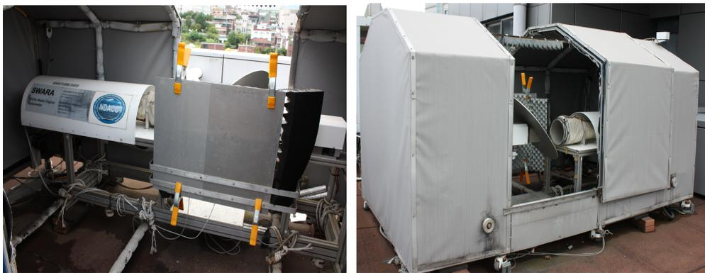
그림 3.8.1 숙명여자대학교 지구환경연구소 22 GHz 수증기 전파수신기(SWARA, Seoul Water vapor RAdiometer).
