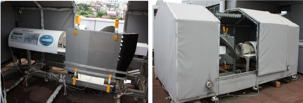
그림 3.8.1 숙명여자대학교 지구환경연구소 22 GHz 수증기 전파수신기 (SWARA, Seoul Water vapor RAdiometer).
