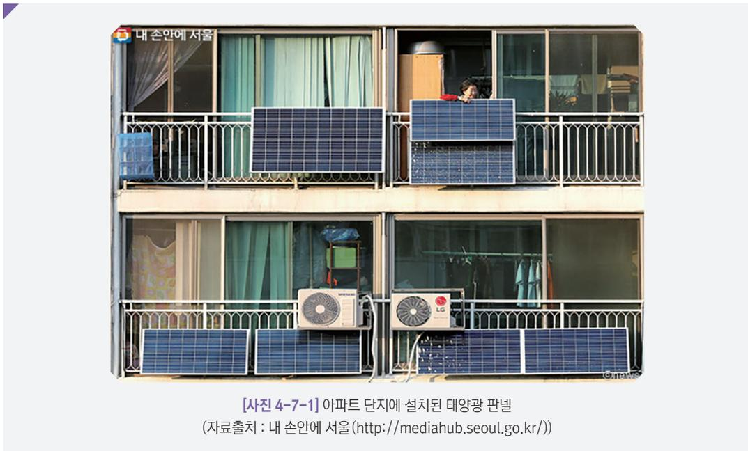
[사진 4-7-1] 아파트 단지에 설치된 태양광 패널
